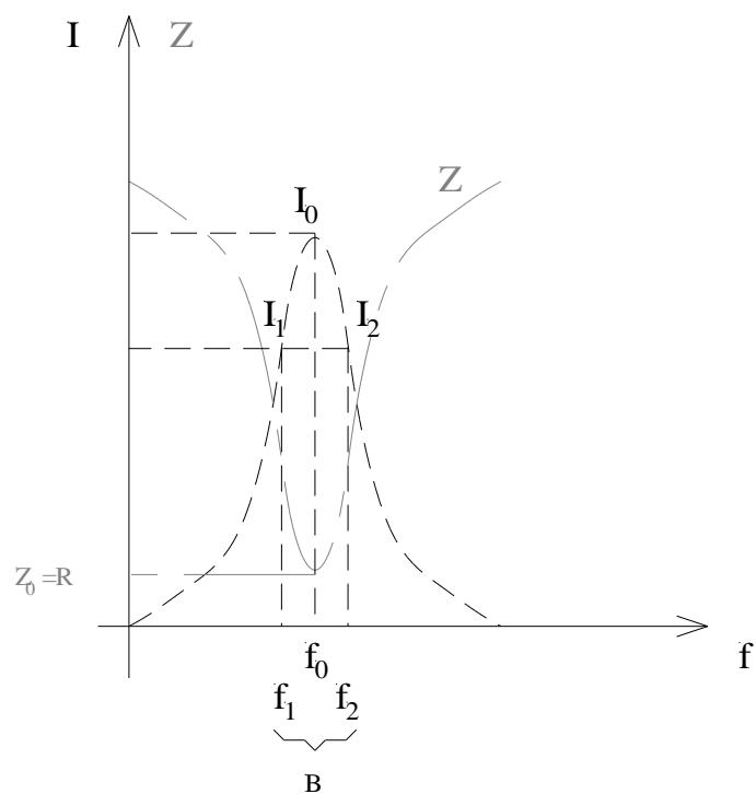
Figur 9.1.7 viser båndbredden  $B = f_2 - f_1$  når  $I_1 = I_2 = \frac{\sqrt{2}}{2} \cdot I_0$ .
